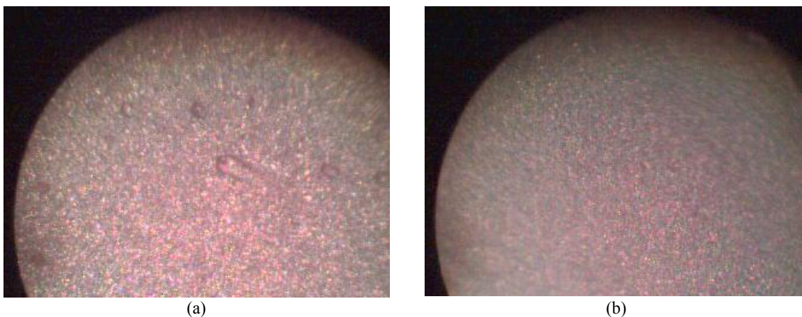
Slika 3 Depozit bakra dobijen na ravnoj površini: (a) jednosmernom strujom; (b) u pulsno-reversnom režimu. Figure 3 Copper deposit obtained on flat surface: (a) using direct current; (b) using reversing current.
