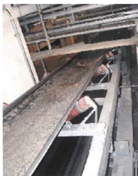
Slika 2. Vraćanje nazad sloja pepela na trakastom transporteru
